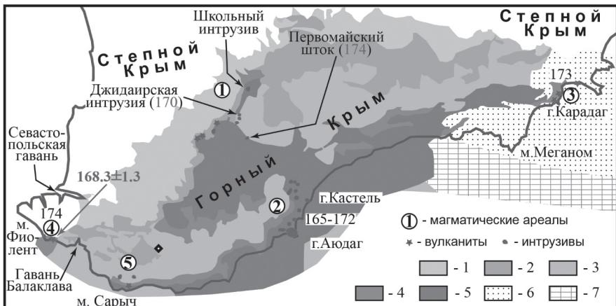
**Рис. 1.** Геологическая схема Горного Крыма по [14] с упрощениями и добавлениями. Цифры в кружках – ареалы позднетриасово (?)–юрского магматизма (цифры – изотопный возраст в млн лет: красный цвет – U–Pb-изотопное датирование по циркону, черный – K–Ar датировка). Пояснения см. в тексте.
