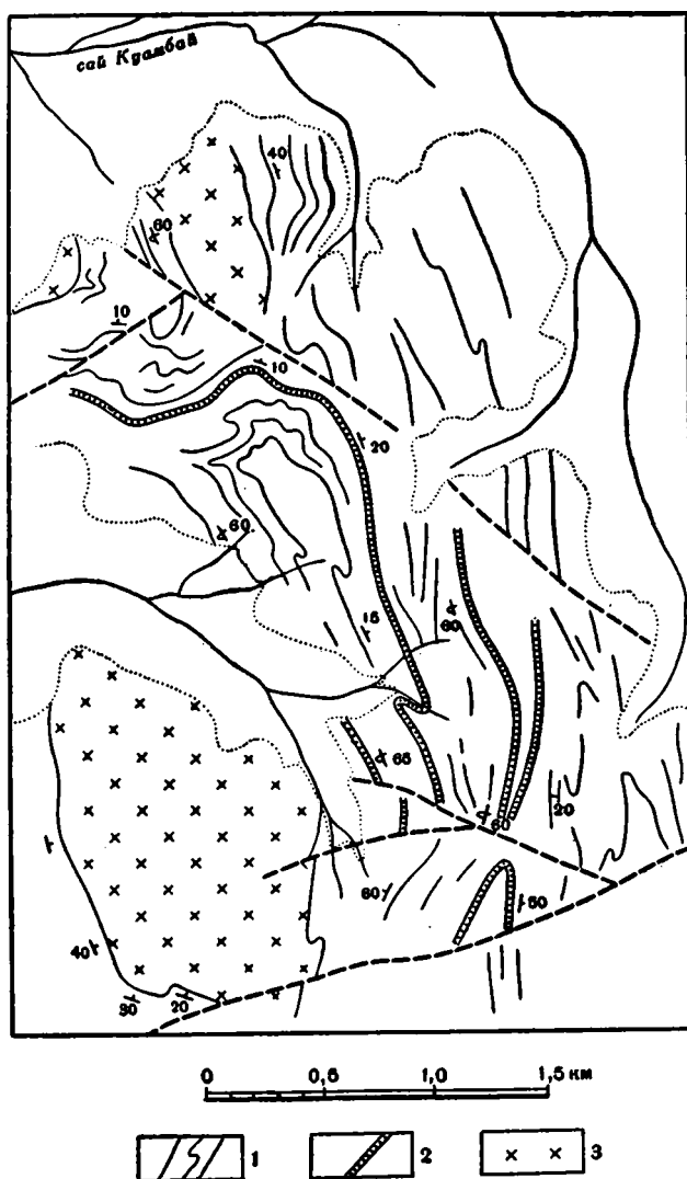
Фиг. 55. Морфология складок в горизонтах разного литологического состава. Куамбайская синклиналь, восточное крыло
