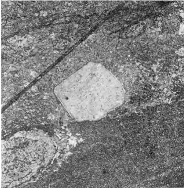
Фиг. 24. Поперечное сечение порфиробласта скаполита в метаморфизованном доломитовом известняке бутунской свиты. Увел. 10. При одном никеле
