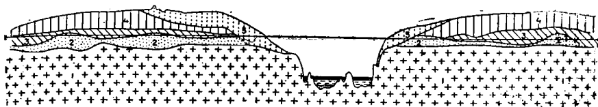
Рис. 2. Геологический разрез по оси плотины Днепростроя.
