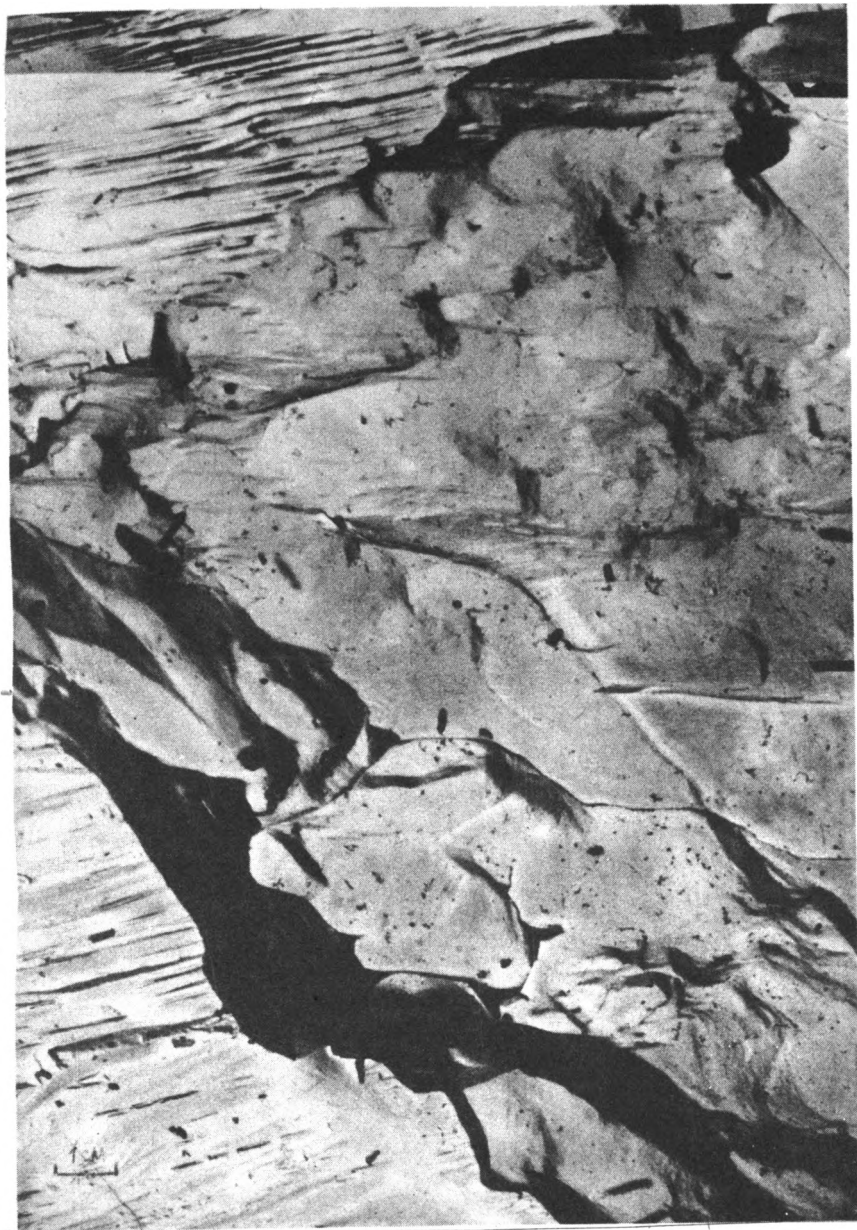
Фиг. 4. Неправильно- и сглаженно-блоковый типы поверхности. Видны выпукло-вогнутые контакты между крупными блоками, местами их деформации. Скв. 80, увел. 8000
