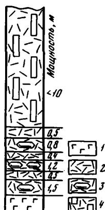
Рис. 2. Разрез цеолитсодержащих пород в районе Джава у сел. Гуфта
