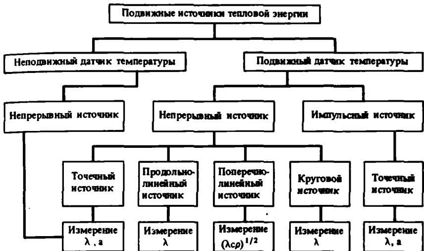
Рис. 1. Теоретические модели для определения тепловых свойств горных пород на основе подвижных источников тепловой энергии
