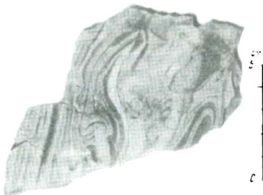
Р и с . 8 . Тuffит тонко-слоистый со складками оползания, средняя толща кремнисто-терригенно-туфогенного комплекса, тонкостратифицированный тип разреза Е, Ж (см. рис. 4)
