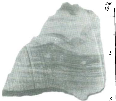
Р и с . 7 . Тuffит, в нижней части с тонкополосчатой, в верхней - с косо́й слоистостью средняя толща кремнисто-терригенно-туфогенного комплекса; тонкостратифицированный тип разреза Е, Ж (см. рис. 4)
