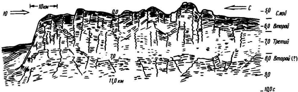
Рис. 11. Сейсмический разрез северного крыла Азоро-Гибралтарского разлома [57]
