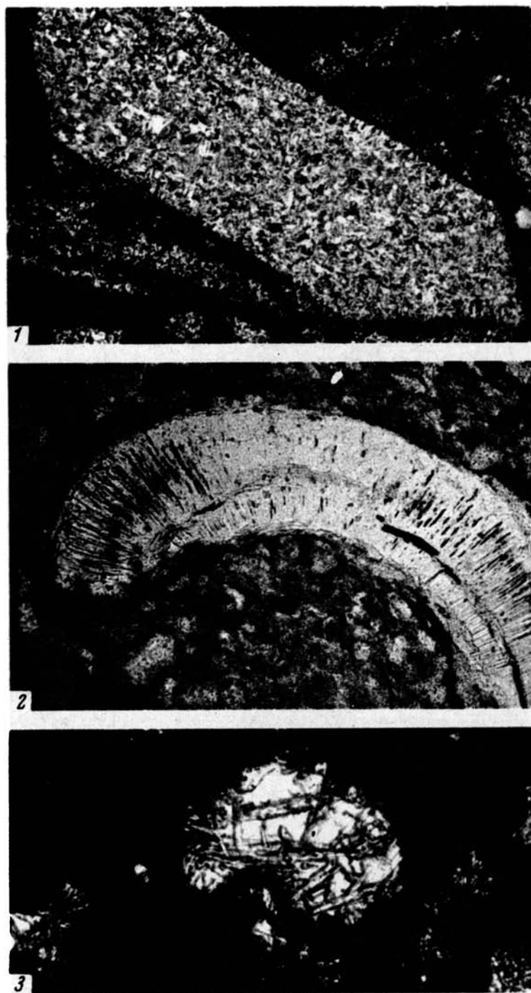
Фиг. 57. Характер вторичных изменений в высокоглиноземистых породах 1 — кристаллы, видимо, плагиоклаза, полностью замещенные гидрослюдой; шлиф, увел. 100, с анализатором; 2 — кристалл лаверьерита; шлиф, увел. 100, без анализатора; 3 — кристаллы диаспора; шлиф, увел. 100, без анализатора
