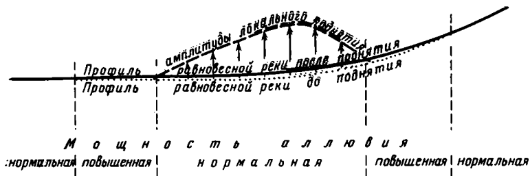
Рис. 19. Схема влияния локальных поднятий на изменения продольных профилей рек и мощности аллювия
