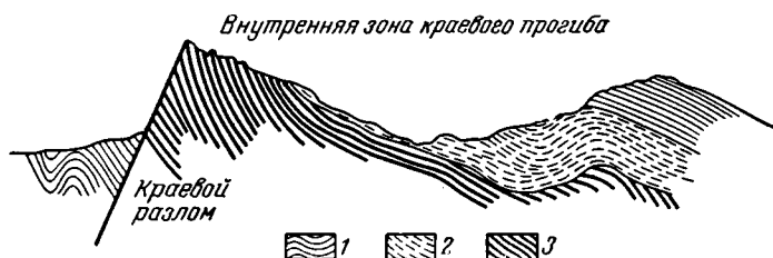
Фиг. 69. Разрез через холмы Джамму, показывающий соотношение пород муррийской серии с более древними породами складчатой зоны.
