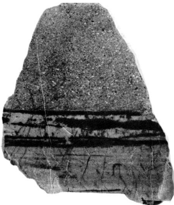
Рис. 21. Чередование серых силицитов с тифрогенными алевролитами, D_3 , кодинская свита, Южный Урал, Пришлифовка
