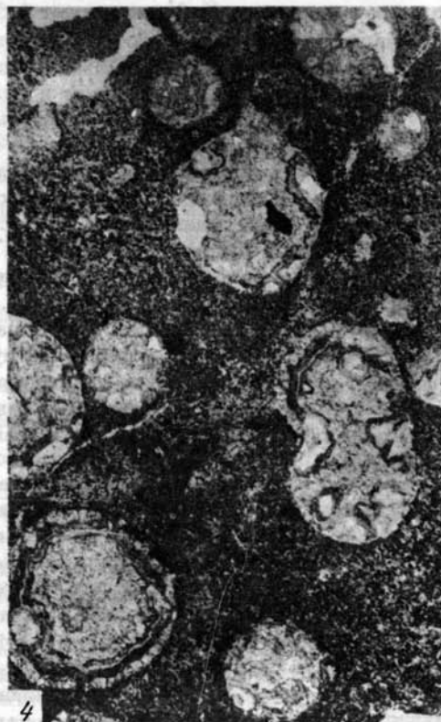
Рис. 39. Туфы и лабы щелочных базальтоидов. Шлифы, без анализатора 1 - хорошо раскристаллизованный базальтоид, \times 70 ; 2 - гиалокластический туф, \times 70 ; 3 - обломок гиалокластита в известняке, \times 20 ; 4 - миндалекаменный базальтоид, \times 20
