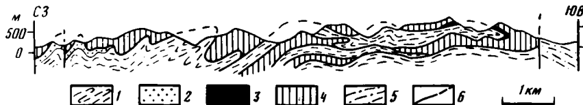
Рис. 12. Геологический профиль через водораздел рек Линлиретваам Первая и Линлиретваам Вторая 1–2 – Накыйлылский покров: 1 – песчаники, алевролиты ( K_1, br - v ), 2 – туфы ( K_1, h ); 3–4 – Эконайский покров: 3 – серпентиниты, 4 – кремни (Т); 5 – песчаники ( K_2, m ); 6 – разломы
