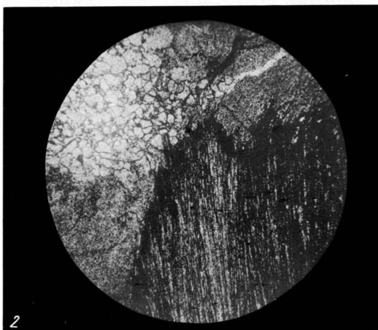
Межзерновая форма выделений свободного углерода, \times 30 , николи II 1, 2 — кянитовые сланцы, свита кяйв, Кольский полуостров
