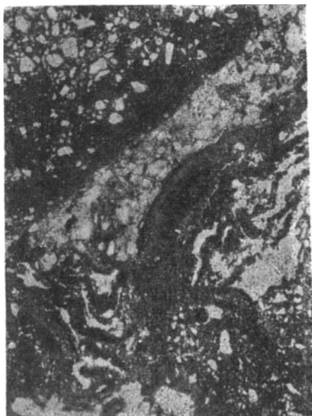
Фиг. 65. Микроструктура песчанистого бобового железняка коскакольской свиты. Увел. 40, ник. ||
