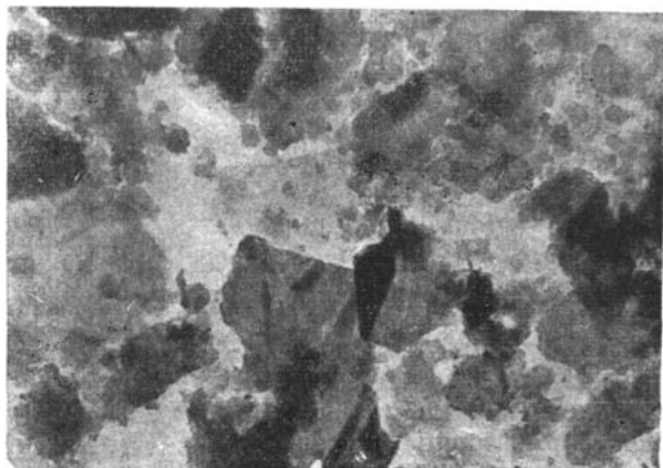
Фиг. 120. Электронная микрофотография обломочного каолинита. Увел. 12 400. Фото Д. Д. Котельникова
