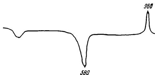
Фиг. 93. Кривая нагревания прожилков галлуазита из бокситовой гальки с бокситового участка Карабаши (район станции Джалтыр)
