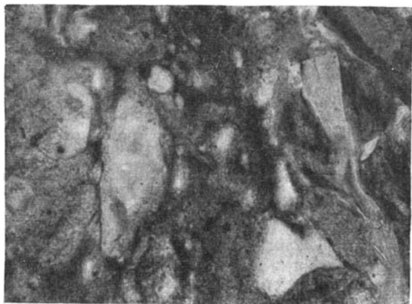
Фиг. 108. Монтмориллонитовый цемент разложения в песках слабокарбонатной красноцветной формации туроп-саптона, хребет Б. Каратау. Увел. 108, ник.~||
