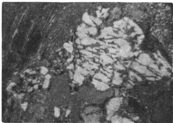
Фиг. 114. Графически источенные зерна кварца в глинистом элювии палеозойских пород. Увел. 54, ник. +
