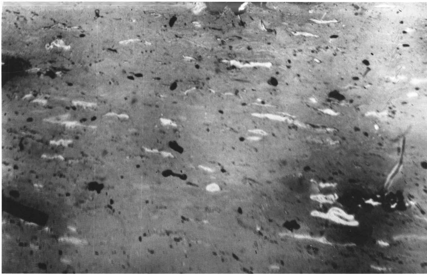
Рис. 37. Гелинито-коллинитовый гумусовый уголь со спорами Увел. 1500. Ник. II. J 2 . Улегхемский угольный бассейн. Тува
