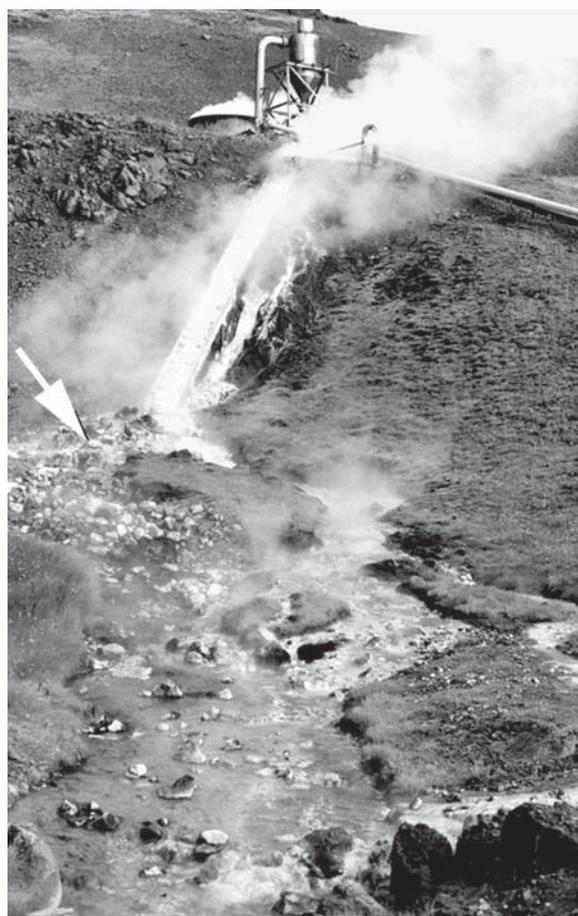
**Рис. 15.** Отложения кремнезёма (стрелка) из горячей воды, постоянно вытекающей из скважины, геотермальное поле Хверагерди (СЭМ)
