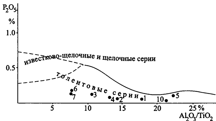
Рис. 54. Диаграмма P_2O_5 - Al_2O_3/TiO_2 для метавулканитов серии полмос-порос Балтийского щита
