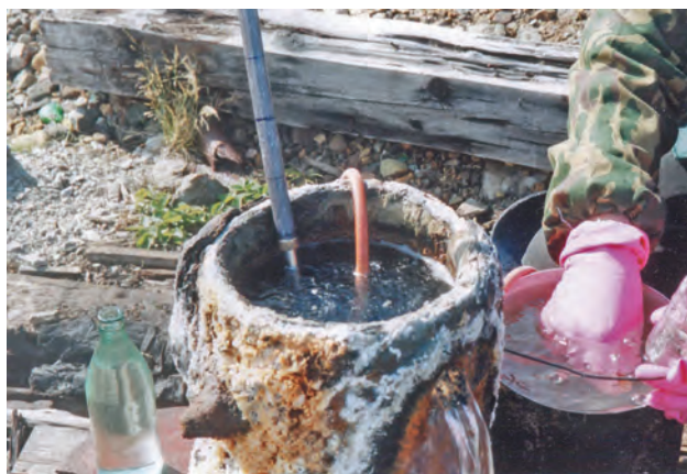
Рис.3.1.1.6. Чаплинские источники, самоизливающая скважина (т. 1а) на склоне г. Утыг. На устье скважины – натечные минеральные новообразования. Фото авторов
