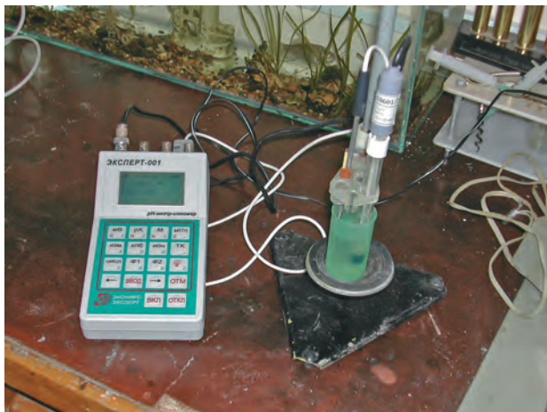
Рис. 2.2. Иономер «Эксперт-001», общий вид прибора, с подключенными ионоселективными (рН) электродами
