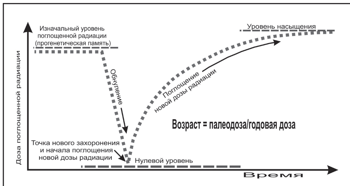
Рис. 3. Принцип дозиметрического датирования в случае переустанавливаемых на нуль (отбеливаемых) образцов
