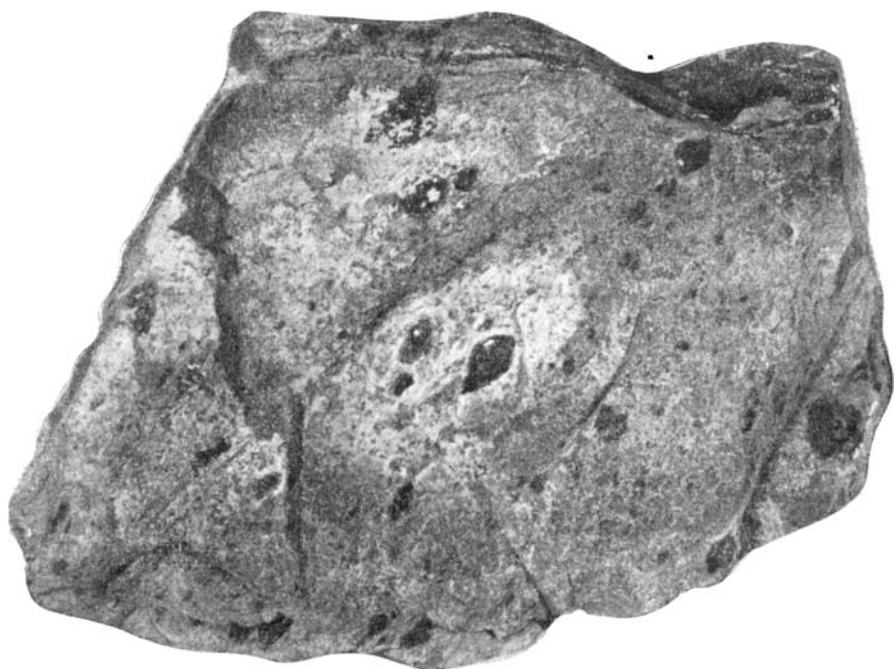
Фиг. 4. Порфиритоид с хлоритизированными вкрапленниками авгита. Белкудукская свита. \frac{1}{2} нат. вел.
