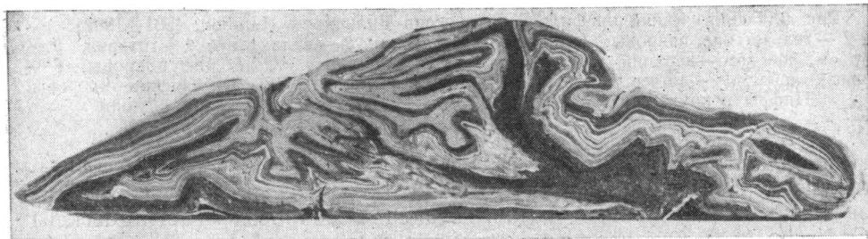
Рис. 7. Модель, характеризующаяся неравномерным разогревом пластилина
