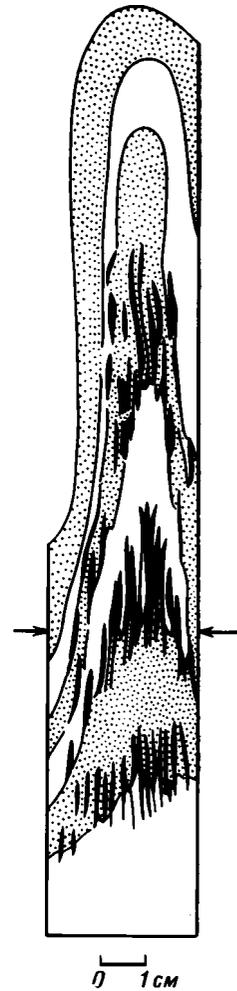
Рис. 2. Разрез деформированного образца с ориентированной текстурой, созданной расплющенными капельками, и с ослабленными поверхностями скольжения (рисунок по фотографии). Слои—90%-ная смесь; черные штрихи—расплющенные капельки, состоящие из 75%-ной смеси; стрелки—направление сжимающих усилий (то же на следующих рисунках)
