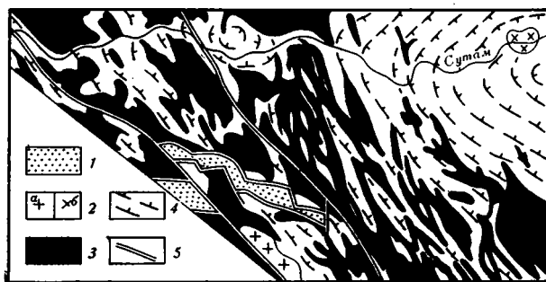
Рис. 6. Геологоструктурная схема бассейна р. Сутам. 1 — грабенообразные впадины, выполненные юрскими осадочными отложениями; 2 — граниты: а — раннепротерозойского и б — позднеюрского возрастов; 3 — архейские гранатовые гранулиты и аляскинские граниты; 4 — катархейские кристаллические сланцы основного состава (показаны замеренные и отдешифрированные на аэрофотоснимках элементы структуры); 5 — разломы
