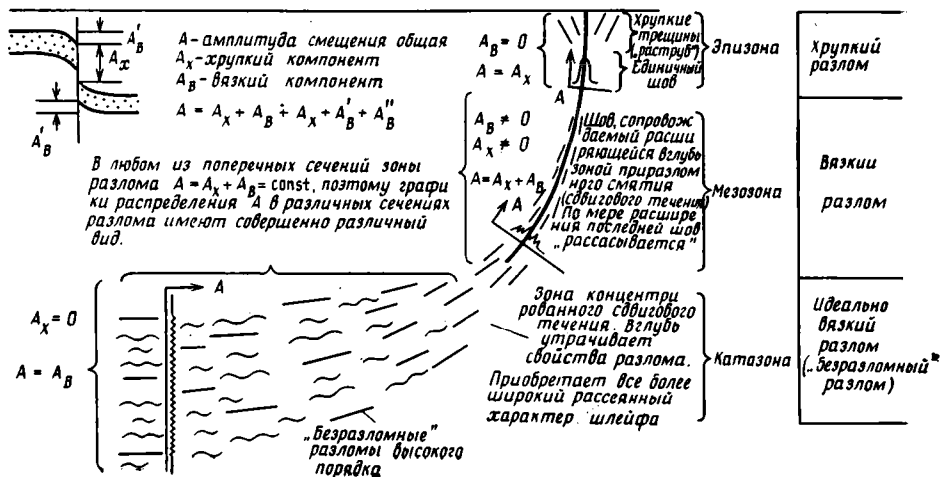
Рис. 9. Модель листрического разлома в разрезе земной коры
