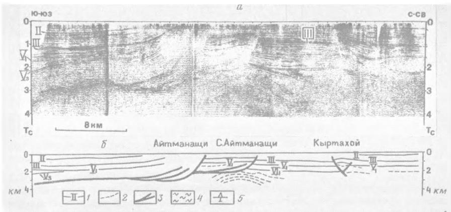
Рис. 1. Сейсмический (а) и сейсмогеологический (б) разрезы, иллюстрирующие надвиговую природу антиклинальных зон Восточного Мангышлака
