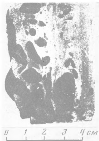
Рис. 6. Включения обломков углеродистых сланцев (черное) в позднефаменско-раннетурнейских песчаниках (серое, светлое). Руденки, скв. 18, 4815 м.
