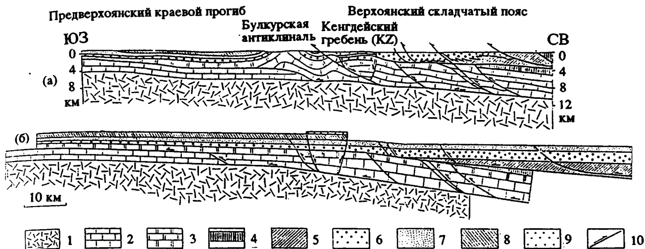
Рис. 2. Геологический (а) и палинстратиграфический (б) разрезы через северные районы Верхоянского складчатого пояса. Составлены Л.М. Парфеновым и А.В. Прокопьевым на основе геологических и сейсмических данных. Положение разрезов см. на рис. 1. 1 – раннедокембрийский фундамент; 2 – 4 – карбонатные отложения: 2 – верхнедокембрийские, 3 – кембрийские, 4 – силурийско-девонские; 5 – 8 – терригенные отложения: 5 – каменноугольные, 6 – пермские, 7 – триасовые и юрские, 8 – нижнемеловые; 9 – третичные отложения; 10 – разломы.
