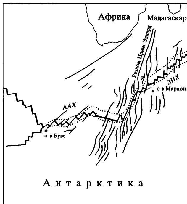
Рис. 4. Разломные структуры Африкано-Антарктического хребта по данным спутниковой гравиметрии [20] Черные линии – разломы. Точками околонтурены хребты. Двойные линии – отрезки рифтовых зон. Хорошо видно сдвиговое смещение хребтов вдоль демаркационной разломной зоны Принс Эдвард. Разломы косо пересекают хребты. Буквенные обозначения: ААХ – Африкано-Антарктический хребет, ЗИХ – Западно-Индийский хребет.
