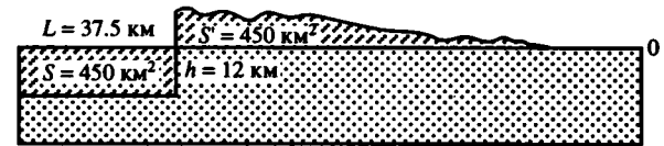
Рис. 8. Схема, иллюстрирующая количественную оценку величины поперечного сокращения Дагестанского клина по линии профиля Б (см. рис. 5) методом площадного баланса
