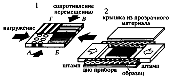
Рис. 1. Схема деформации образцов (1) и прибор (2), в котором производилась деформация. На схеме 1 в образце показаны типы неоднородностей и их положение по отношению к действующим силам.
