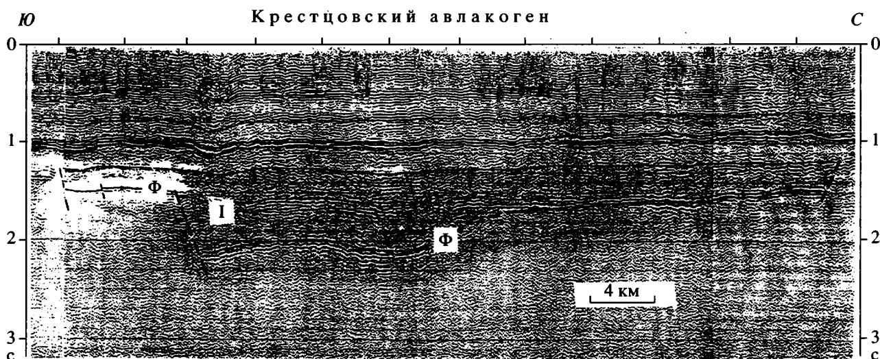
Рис. 2. Фрагмент временного разреза по профилю ОГТ 029301 через Крестцовский авлакоген, иллюстрирующий наличие горизонтальной слоистости в осадочно-магматической толще (I), заполняющей максимальные погружения поверхности кристаллического фундамента (Ф). Местоположение профиля см. на рис. 5.
