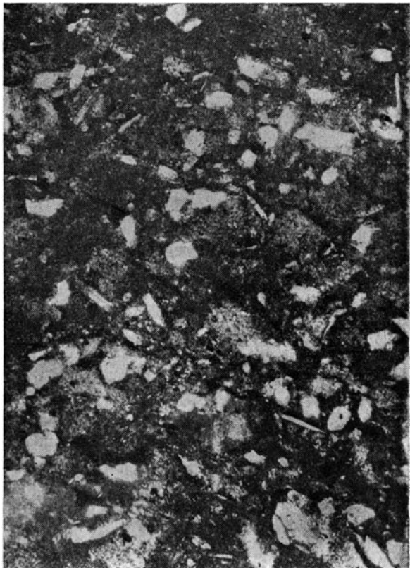
Фиг. 5. Микрофотография нижнего слоя оксфорда (абс. отм. 124.84 м). Многочисленные известковые включения в песчано-глинистой массе породы. Николи ||, \times 75 .
