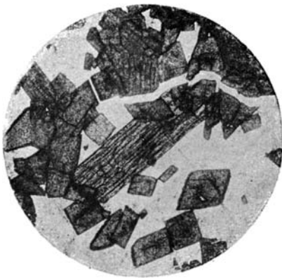
Фиг. 49. Спайность у касситеритов из месторождений сульфидно-касситеритовых формаций; месторождение Бургавли. \times 24 . Без анализатора.
