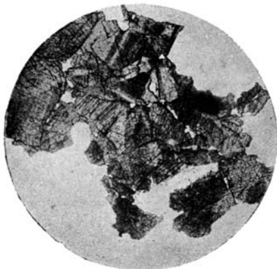
Фиг. 43. Пятнистая и зональная окраска у касситерита из месторождения Бутыгычаг (кварц-касситеритовой формации). \times 24 . Без анализатора.
