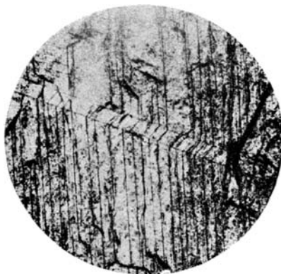
Фиг. 46. Спайность по двум направлениям 100 и 110, наблюдавшаяся у некоторых пневмато-эндогидатогенных касситеритов из месторождения Иультинское. \times 24 . Без анализатора.
