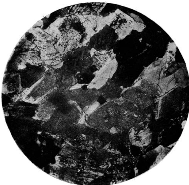
Фиг. 2. Гранит серый № 1294. Плагиоклаз альбитизирован и содержит внутри выделения вторичного кальцита. Увел. 16. Николи скрещены.
