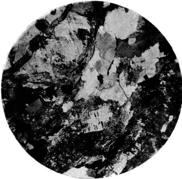
Фиг. 3. Гранит серый № 150. Микроклин пертитизирован. Кварц сильно раздроблен. Шлиф сечется более поздними кварцево-хлоритовыми жилками. Увел. 16. Николи скрещены.
