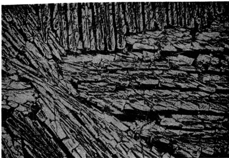
Фиг. 1. Тефронит в шлаке № 57 от выплавки ферромарганца, Свет простой, \times 20 .
