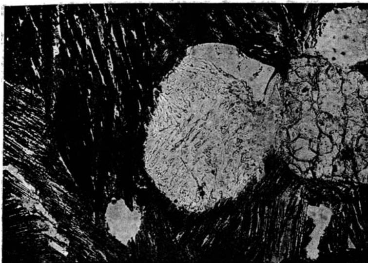
Фиг. 3. Микрофото нормального шлака 13 отражательной печи: реликты кварца и пироксен в стекле. Никולי параллельны, \times 140 .
