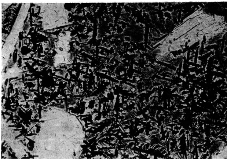
Фиг. 8. То же: видны поперечные ромбические разрезы кристалликов муллита. Николи параллельны, \times 140 .
