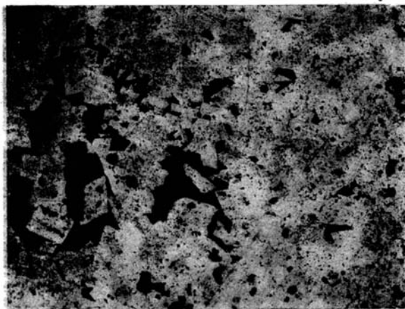
Фиг. 7. Синдетическая структура доломита № 340 после травления аншлифа HCl. Отраженный свет, \times 17 .
