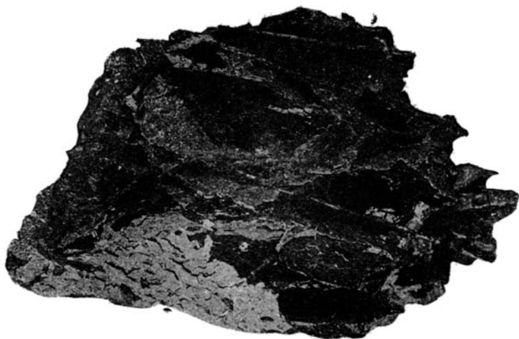
Фиг. 7. Крупные кристаллы корунда в шлаке № 71-а от выплавки металлического хрома. 0.8 натуральной величины.
