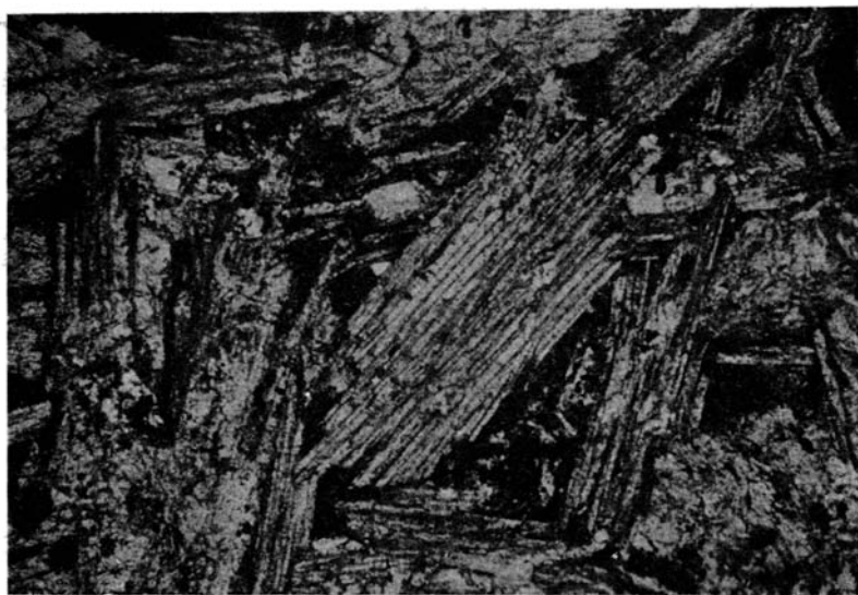
Фиг. 8. Пластинчатые кристаллы корунда с трещинками отдельности по базопинакноиду в шлаке № 71-а металлического хрома. Свет простой, \times 45 .
