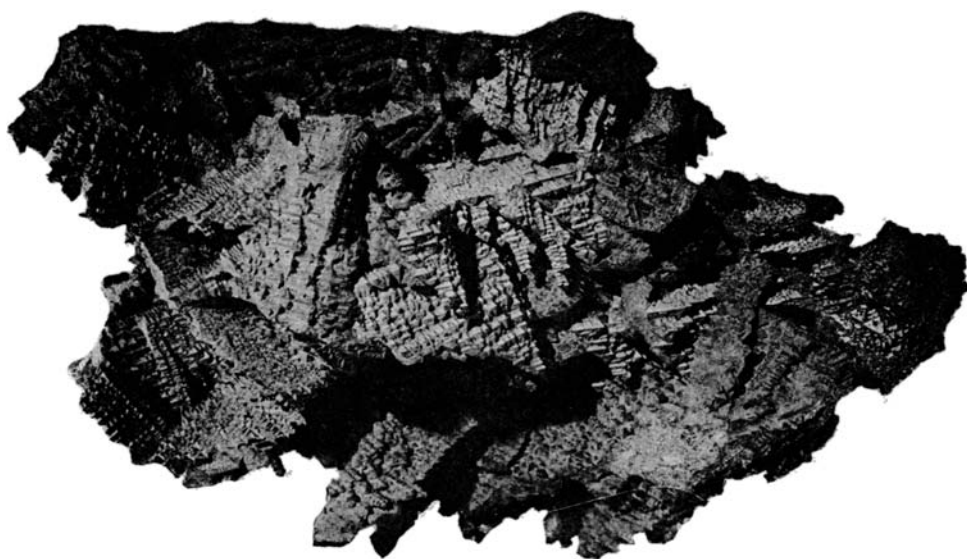
Фиг. 4. Сrostки марганцевой шпинели в шлаке № 65 металлического марганца. 0.7 натуральной величины.
