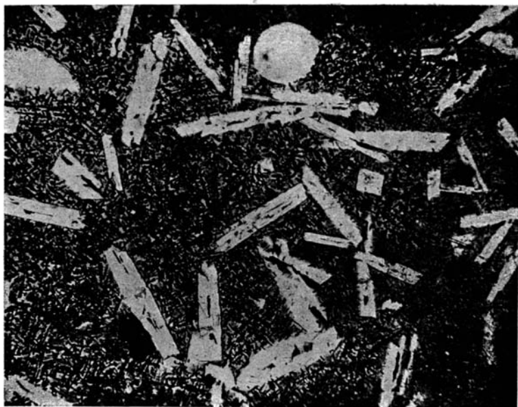
Фиг. 5. То же, шлак 6, анортит, магнетит, стекло. Николи параллельны, \times 45 .
