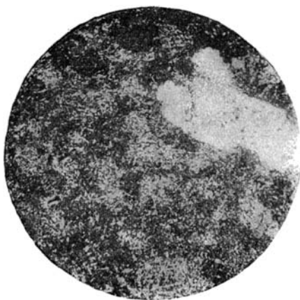
19. Ортофир. Обр. 549. Видны кор- родированные вкрапленники поле- вых шпатов в микропйкритовой основной массе. \times 25 . Николи \times .
