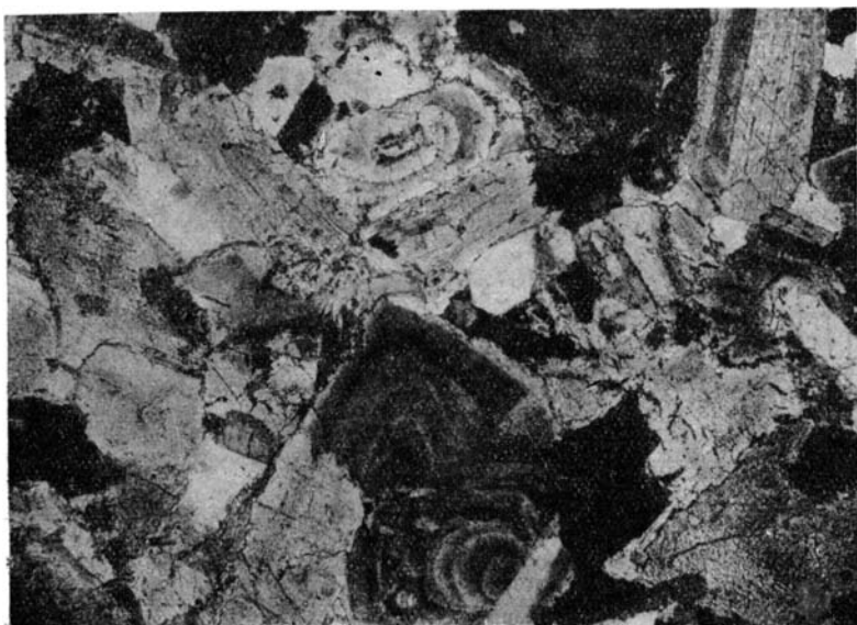
Фиг. 3. Зональное строение плагиоклазов в гранодиорите (шлиф № 43; \times 20 ; николи +).
