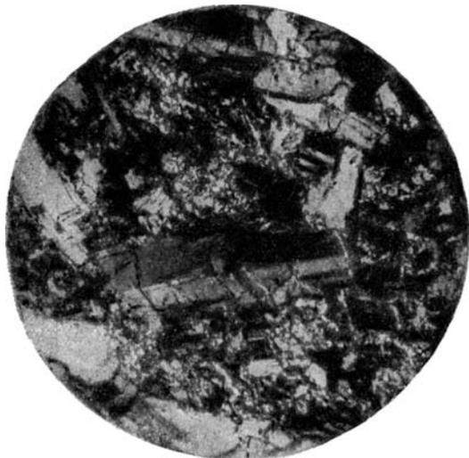
Фиг. 22. Лейкодиабаз. Структура неравномернозернистая. Заметен слабый катаклаз. у более крупных зерен. Река Дзамараш-дон, № 121, × 10.
