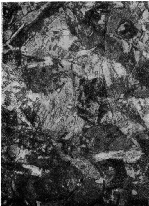
Фиг. 19. Диабаз. Структура — переходная от офитовой к габброидной. Серые зерна — пироксен, белые — плагиоклаз. В левом верхнем углу — зерно плагиоклаза с полностью сосюртитизированным ядром (черное) и свежей альбитовой каемкой. Дол. р. Фиаг-дон, № 20,  $\times 20$ .
