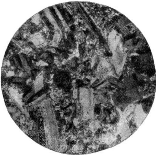
Фиг. 40. Лейкодиабазы с неравномерно-зернистой структурой. Лейсты плагиоклаза, разнообразных размеров и формы, сцементированные хлоритом. Река Цирцловнисцхали, № 154,  $\times 20$ .
