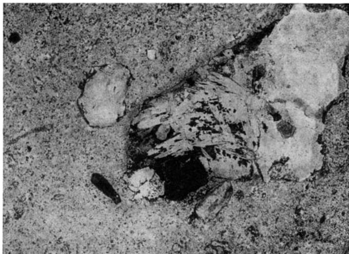
Фиг. 9. Интрателлурическое включение в фельзитовом туфокератофире, представляющее агрегат полевошпатовых вкрапленников, сцементированных гематитом и хлоритом. Район сел. б. Хулам, № 684,  $\times 20$ .
