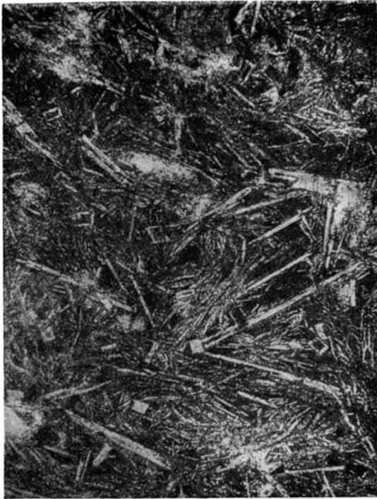
Фиг. 27. Диабазовый витрофир. Видны более крупные игольчатые лейсты плагиоклаза на фоне плотной массы, состоящей из агрегата тончайших микролитов авгита и плагиоклаза. Река Фиаг-дон, № 980 × 20.
