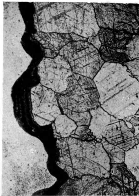
Ф и г. 6. Образец № 3. В шлифе видна темная каемка на поверхности мрамора. × 20.
