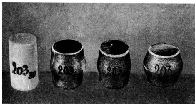
Ф и г. 2. Внешний вид исходного и деформированных образцов.
