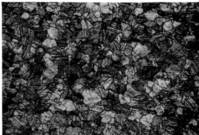
Ф и г. 1. Микроструктура исходного материала. Мрамор Прохорово- Баландинского месторождения. Николи ||, \times 50 .
