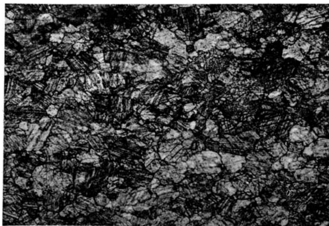
Ф и г. 8. Микроструктура образца, подвергнутого только всестороннему сжатию, равному \sim 14000 кг/см 2 . Мрамор Прохорово-Баландинский. Николи ||, \times 50 .
