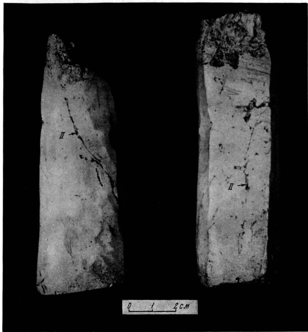
Фиг. 8. Колонка донных отложений, снятая с двух разных сторон. Вверху остракодовый ил, отделяющийся неровной границей (I) от подстилающего серого ила. В средней части тонкая крутая трещина (II) в сером иле; она заполнена материалом из вышележащего слоя и содержит неправильные включения остракодового ила. Средняя часть Западного плеса.
