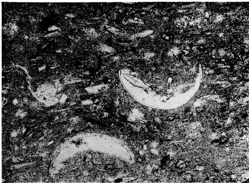
Фиг. 18. Ил слоистый тот же, что и на фиг. 17. Прослой известнистой разности ила с раковинками остракод и скорлупками диатомовых. Ув. 145, николи ||.
