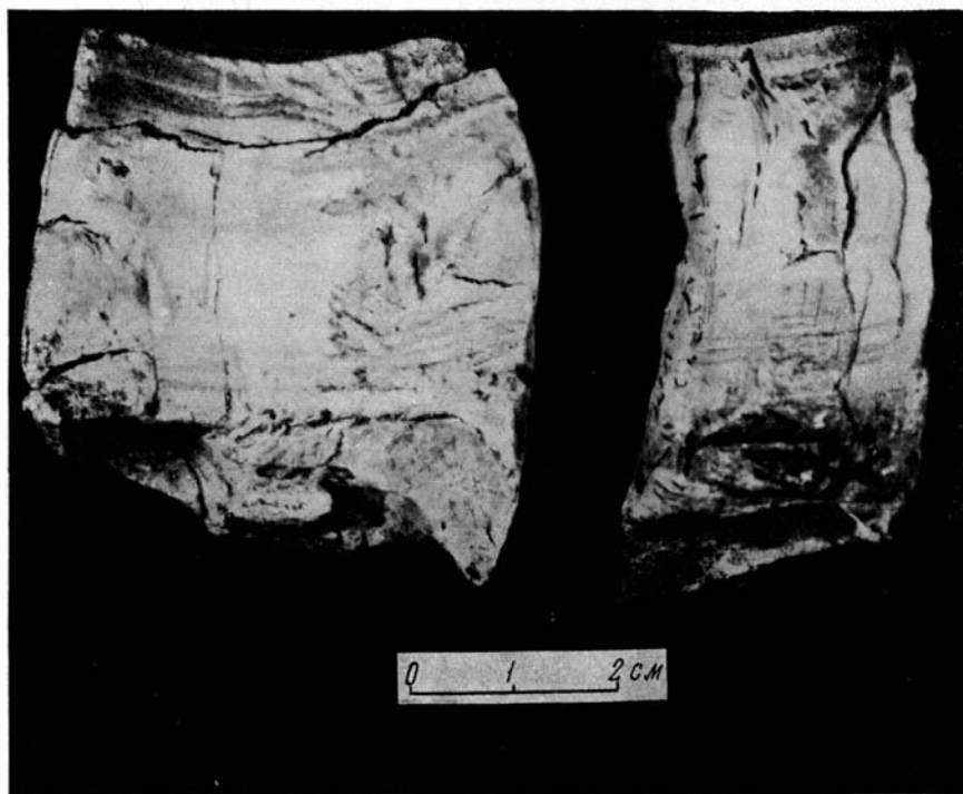
Фиг. 17. Ил тонкослоистый в верхней и нижней частях. Бурлю-тюбинский плес, образец из точки 2 (см. колонки на фиг. 20).
