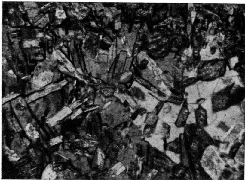
Фиг. 13. Ксенолит кварцевого микроклинового амфиболита. Идиоморфные включения плагиоклаза и роговой обманки в кварце и микроклине. Николи скрещены, увел. 46.
