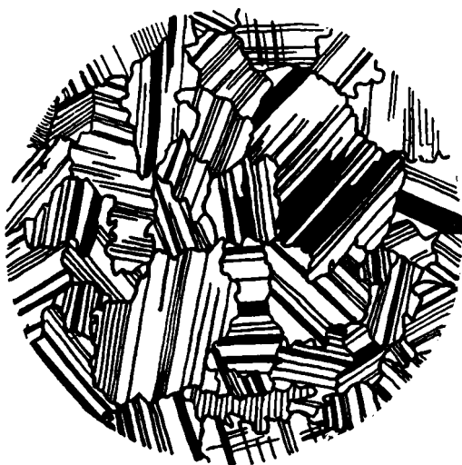
Фиг. 8. Структура плагиоклазового участка в дайке гранита. Лейсты принадлежат плагиоклазу № 40—50. Никולי скрещены, увел. 76 (зарисовка).
