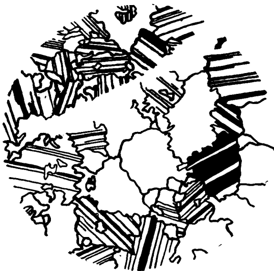
Фиг. 7. Участок гранита в контакте с известняками. Лейсты плагиоклаза № 45—47 значительно замещены кварцем. Порода — «лабрадоровый аплит», 51% плагиоклаза, 49% кварца. Николи скрещены, увел. 20 (зарисовка).
