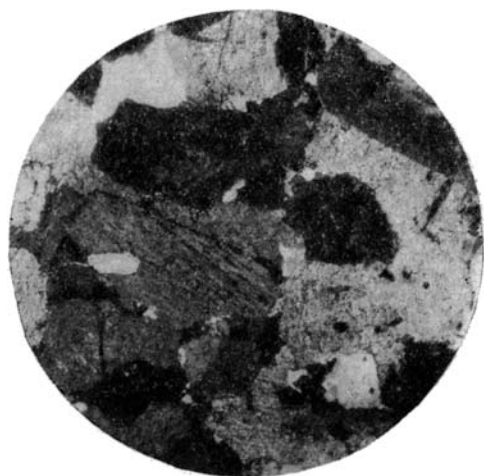
Фиг. 10. Дайка «гранита» в известняках. Состоит из зерен анортоклаза — 75% и кварца — 25%. Никели скреплены, увел. 20.
