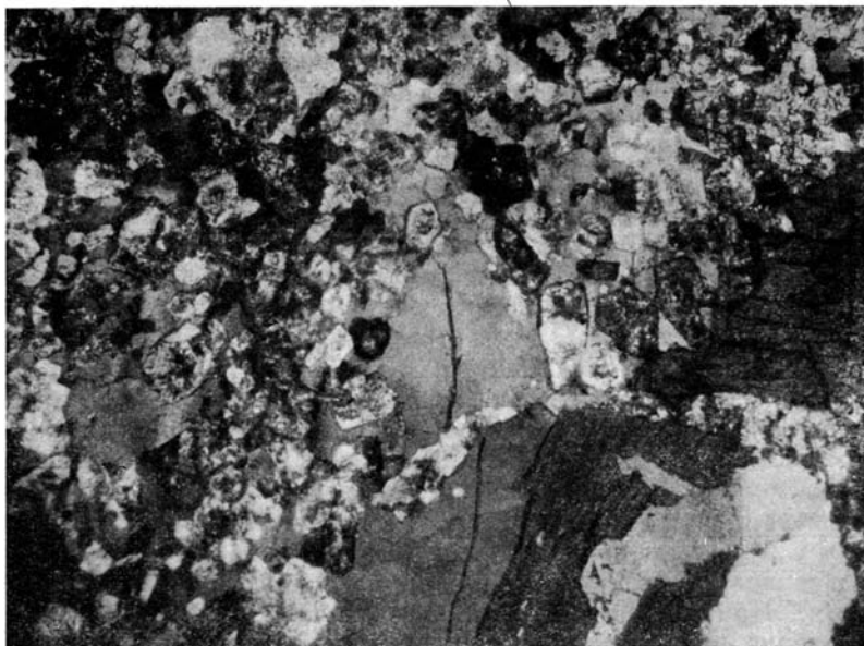
Фиг. 8. Лейкокатовые инъекционно-контактовые гибридные породы кварцево-диоритового состава. Большие зерна кварца, содержащие идио-морфные включения плагиоклаза. Николи скрещены, увел. 46.
