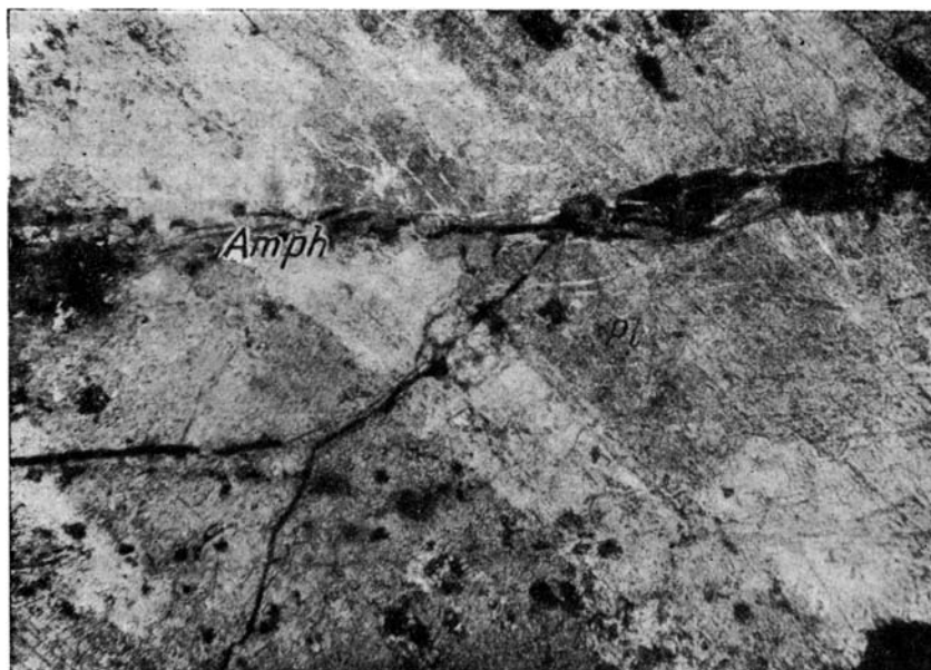
Фиг. 8. Прожилки амфибола ( Amph ) в плагиоклазе ( Pl ). Николи скрещены, увел. 78.
