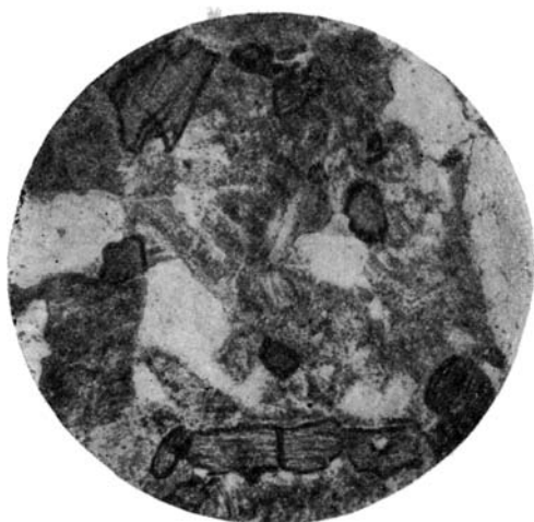
Фиг. 9. Дайка «гранита» в известняках. Серое — анортоклаз, белое — кварц, темное — пироксен. Без анализатора, увел. 46.
