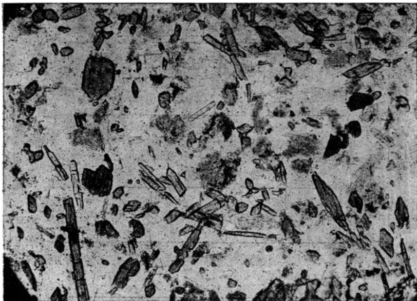
Фиг. 12. Ксенолит микроклинового амфиболита. Идиоморфные включения роговой обманки в микроклин. Без анализатора, увел. 46.
