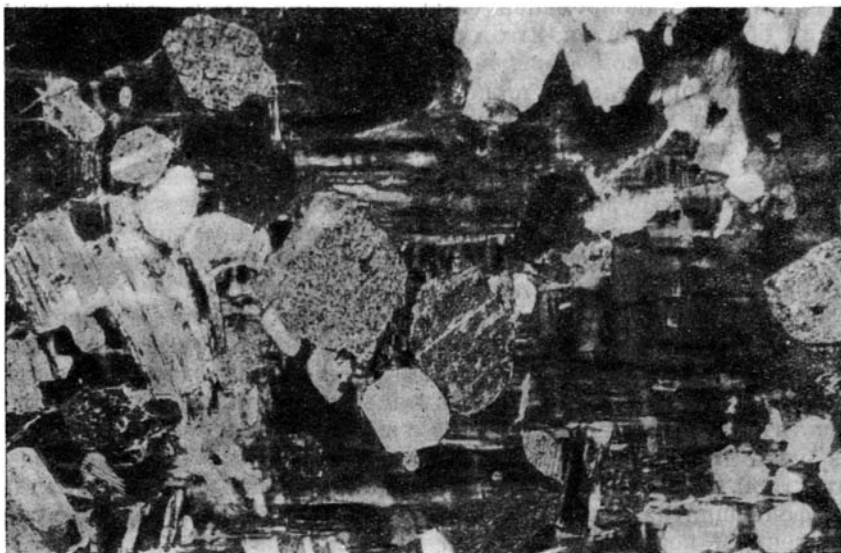
Фиг. 6. Порфиробласта микроклина в кристаллическом сланце контактного ореола Кочергинской интрузии аляскитов. Вся фотография — один кристалл микроклина, включающий захваченные составные части кристаллического сланца. Николы скрещены, увел. 100.
