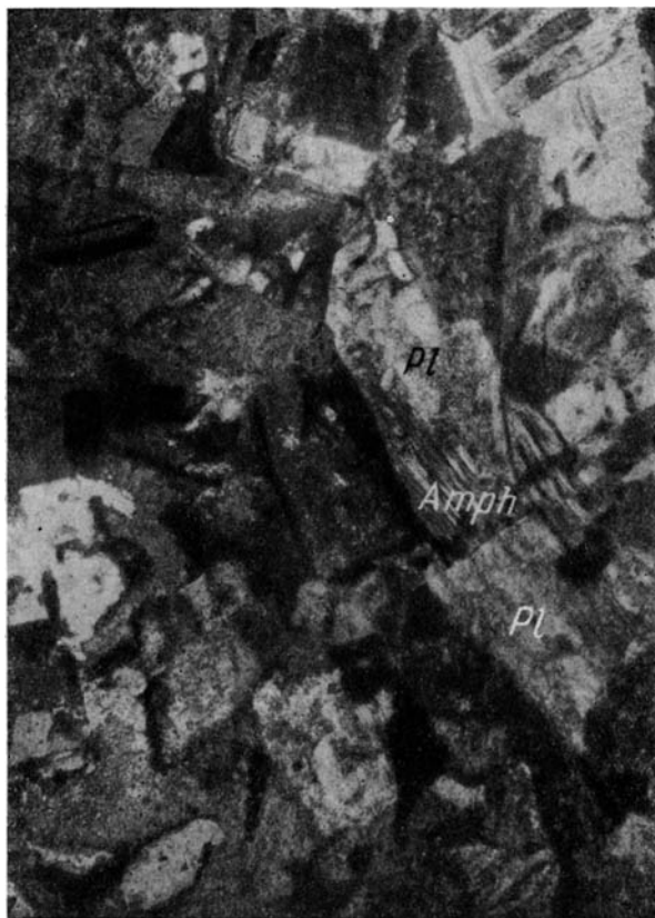
Фиг. 13. Офитовая структура в кварцевом монцоните: Pl — плагиоклаз, Amph — амфибол. Николи скрещены, увел. 44.
