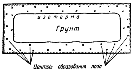
Фиг. 5. Схема образования льда в грунте при замерзании
