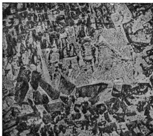
Фиг. 16. Микропегматитовая структура в доменном высокоглиноземистом шлаке 1. Вростки  $\text{CaO} \cdot \text{Al}_2\text{O}_3$  (темное) в гелените (светлый). Полированный шлиф после травления 2% раствором  $\text{NaOH}$  при  $100^\circ$  — 13 минут, 120 х.
