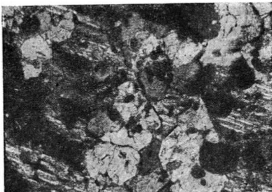
Фиг. 3. Прорастания мервинита (двойники) и монтичеллита в шлаке 12 металлического никеля. Николи скрещены, 86 х.
