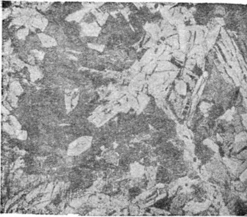
Фиг. 17. Гипидиоморфнозернистая структура шлака 8 металлического никеля. Ni- и Co-содержащий окерманит (удлиненные кристаллы) и форстерит (шестиугольные разрезы). Николи скрещены, 20 х.
