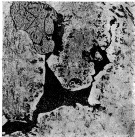
Фиг. 40. Альбитовая каемка в контакте сульфидов (черные) с серицитизированным плагиоклазом. Серое зерно — апатит. Шлиф 50, прозрачный. \times 45 . Ник. под углом 45^\circ
