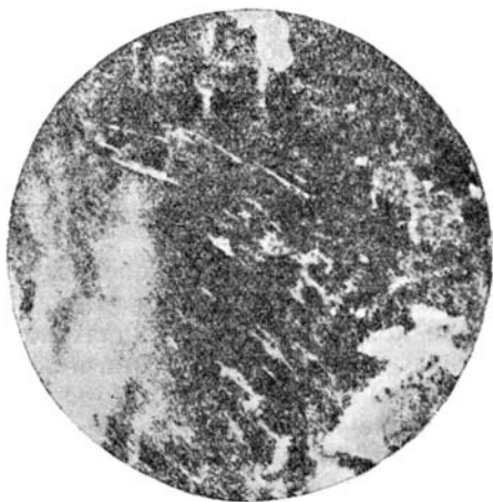
Фиг. 5. Плагиогранит. Козиевка (коростышевский тип), обр. № 16. Видно развитие вторичного микроклина, замещающего по краям плагиоклаз. \times 12 . Ник. \perp
