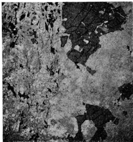
Фиг. 38. Контакт меридиональной жилы с амфиболитом. Влево — биотитизированный амфиболит, вправо — плагиоклазовый зальбанд жилы с шеелитом (темносерый). Шлиф 85, прозрачный. \times 50 . Ник. +
