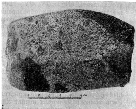
Фиг. 6. Обр. № 145. Контаминация гранита диабазовым материалом
