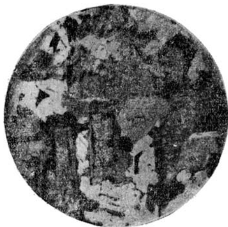
Фиг. 8. Гибридная порода. Обр. № 140. × 20. Ник. +. Довольно много кварца
