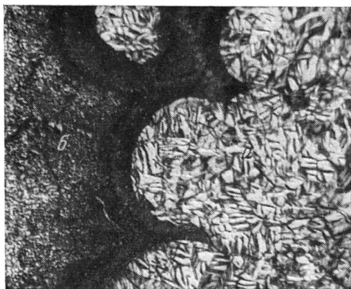
Фиг. 4. Микроструктура слоистой гальки. Плоскость, близкая к наслоению а — блестящий слой, б — матовый слой. Аншлиф 38, увел. 30, с анализатором
