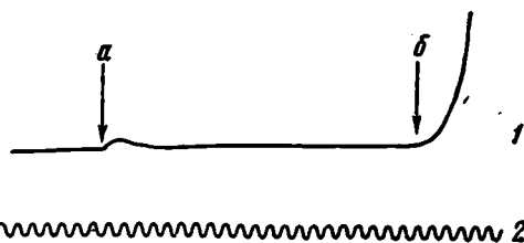
Фиг. 2. Сейсмограмма времени пробега ультразвукового импульса в образце (1) и масштаб времени (2)
