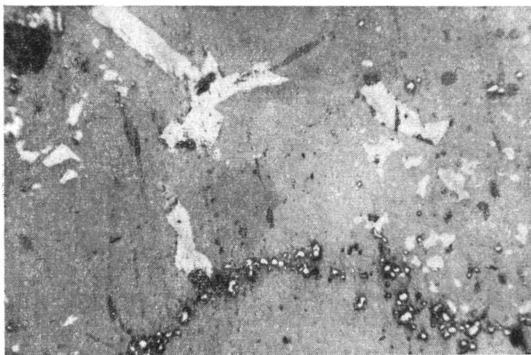
Фиг. 4. Концентрация рудных минералов у стилолитовых швов. Месторождение Узунжал
