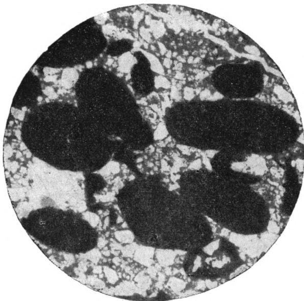
Фиг. 1. Гётитовые оолиты в мелкозернистом песчанике Без анализатора, увел. 60
