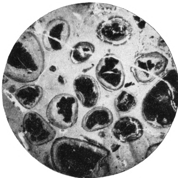
Фиг. 3. Зерна окисленного глауконита, составляющие ядра оолитов (черное), обволакиваются хлоритовыми концентриями. Цемент руды хлоритовый. Кыз-Аульская мульда. Увел. 18
