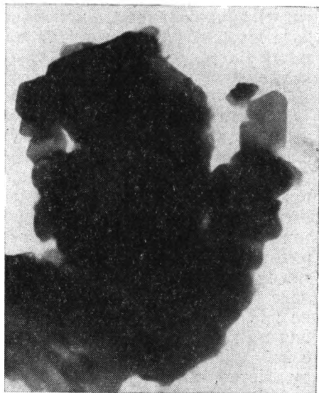
Фиг. 7. Электронно-микроскопический снимок. Пакеты каолинита из цемента аркоза. Обр. 19а, свита C_2^5 , гл. 3856 м, увел. 30 000
