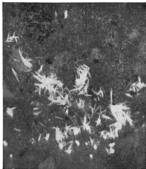
Фиг. 5. Пластины пирротина (белое) и выросшие на них более тонкие пластины смайтита (белое) среди карбонатной массы. Полированный шлиф, увел. 320
