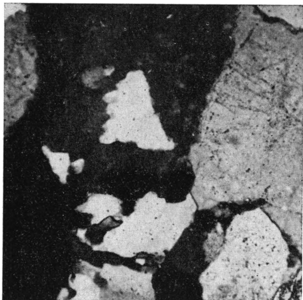
Фиг. 6. Каолининовый цемент в «незапечатанной» поре при регенерации кварца и стилолитовом сочленении зерен. Обр. 19а, увел. 200
