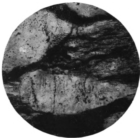
Фиг. 7. Участок проявления «сквозных движений» с многочисленными поверхностями кливажа разрыва (темные полосы) Песчаник ашинской свиты, увел. 100, при одном николе
