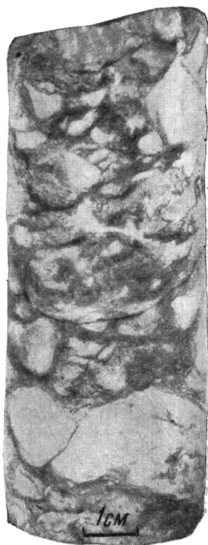
Фиг. 3. Седиментационная брекчия растрескивания примерно с равным количеством обломков известняка (белое) и цемента алевропелитового состава (серое). В цементе мелкие (до 1 мм) обломки барита, кварца, сфалерита, галенита и пирита
