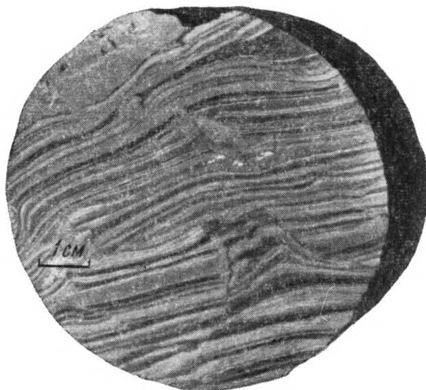
Фиг. 8. Сплошная тонкополосчатая пирит-сфалеритовая руда с редкими прослойками аргиллит-алевролита (темно-серое). Пирит — светло-серое; сфалерит — серое.
