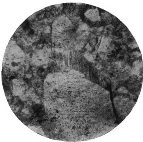
Фиг. 8. Участок проявления стресса в виде однозначной — параллельной ориентировки чешуйчатых минералов (кливаж течения) Песчаник ашинской свиты, увел. 120, при одном николе..., николи +
