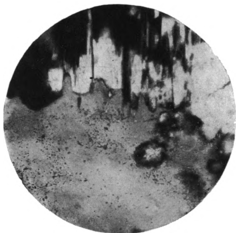
Фиг. 3. Микростилолитовое сочленение зерна кварца с каемкой вторичного альбита Песчаник ашинской свиты, увел. 200, николи +
