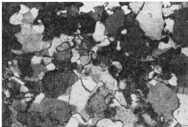
Фиг. 2. Роговиковая структура кварцита на контакте с габбро-диабазой Никели +, увел. 96
