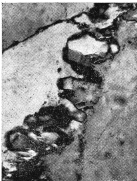
Фиг. 6. Рекристаллизационно-грануляционный бластический контакт между зернами
