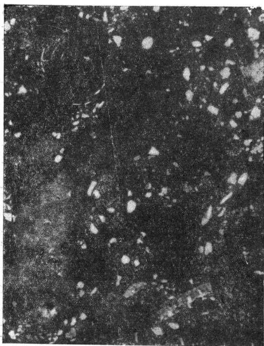
Фиг. 3. Мелкооолитовая гидрогетитовая руда (1 тип), увел. 25, без анализатора
